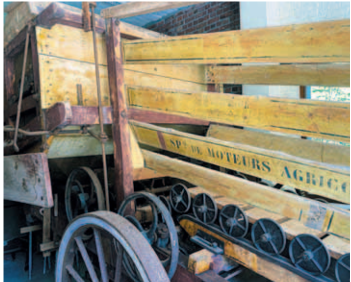
La batteuse à plan incliné, activée par un cheval pour moteur. © Paper-Menthe
